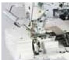
Dispositivo elettromagnetico rasafilo aghi e crochet
